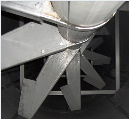
Abb. 6: Rührwerk einer Biogasanlage (Foto: DBFZ).
