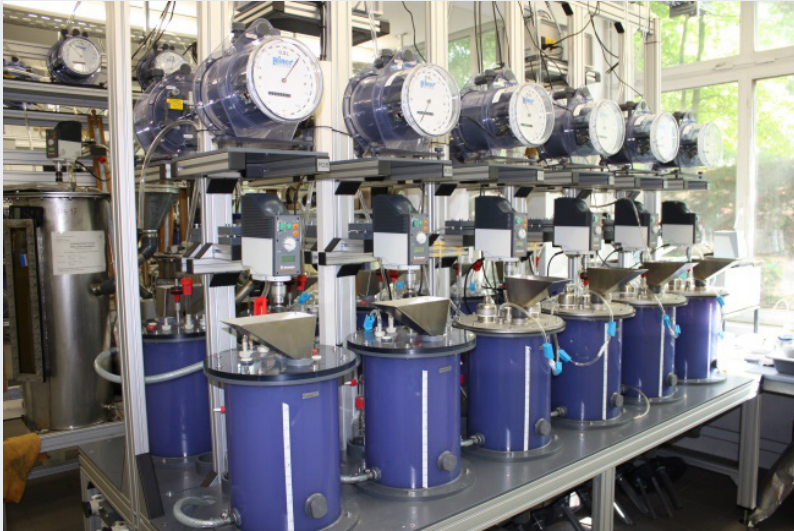
Abb. 1: Versuchsstand mit Laborbiogasreaktoren im Biogaslabor des DBFZ. (Foto: DBFZ)
