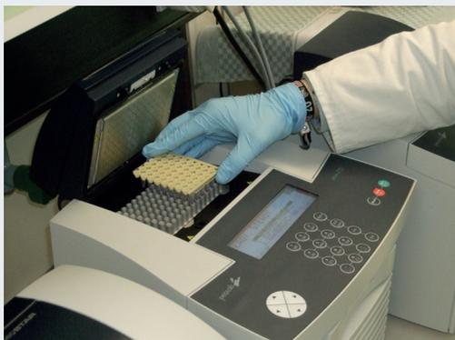
Abb. 23: DNA-Analyse mittels Polymerase-Kettenreaktion
